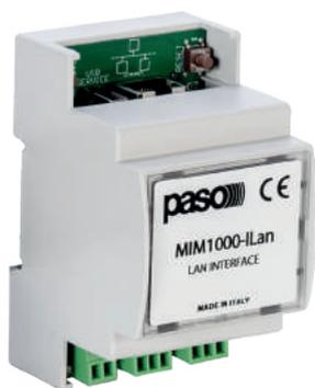
Il modulo interfaccia **MIM1000-ILan** è un sistema di supervisione su rete IP per impianti EN54 e dispositivi audio **SOURCE1000**, che ne consente la gestione tramite APP dedicata; è compatibile con i sistemi d'evacuazione compatti all-in-one Serie **PAW4500-VES**, **PAW5500-VES** e **PAW51K-VES** e con i moduli multisorgente **SOURCE1000**.
