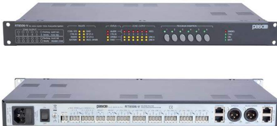
Il router **RT8506-V** è la soluzione ideale per gli impianti di amplificazione di qualità con un rapporto prezzo/prestazioni molto interessante; è un'unità di espansione zone che, collegata ad una linea di controllo proveniente dal CR8506-V, è in grado di gestire fino a 6 zone con amplificatori esterni di potenze variabili (AW5600) per un massimo di 1000 W.
