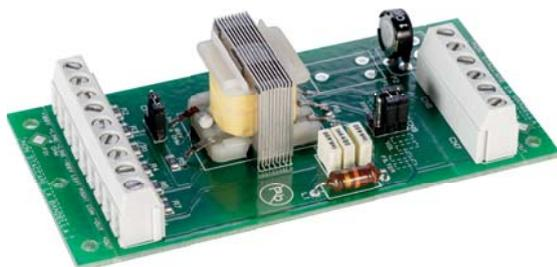
Il modulo **ACLTR1** consente l'interfacciamento di segnali audio tramite trasformatore di separazione galvanica.
