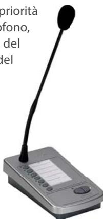
**PMB112-G | Postazione preamplificata** con 12 pulsanti di selezione zona programmabili e relativi led indicatori, un tasto di selezione generale, un tasto di chiamata a rilascio (PTT), uno a ritenuta (LOCK) per messaggi lunghi e un led di attivazione microfono e di occupato.
