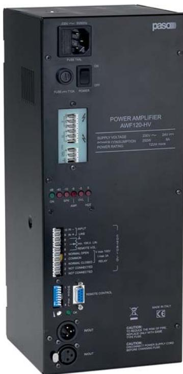
La peculiarità di questa gamma di amplificatori industriali consiste nella capacità di sopportare la presenza di elevate tensioni tra alimentazione di rete/uscite altoparlanti e telaio, che possono arrivare fino a 4 kV. Questa caratteristica aumenta la sicurezza dell'impianto, impedendo che una scarica sulla rete o sulle connessioni altoparlanti possa risalire la catena audio e provocare gravi danni a cose o persone.
