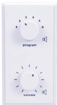
Il selettore per linee a tensione costante **TLS60-RE** permette la commutazione di 6 programmi diversi da linee a tensione costante, su uno o più altoparlanti. E' inoltre dotato di attenuatore da 60 W con relè di by-pass in grado di escludere l'attenuatore stesso in presenza di un segnale prioritario di allarme e/o emergenza (attivazione del relè tramite 24 Vcc su linea bipolare aggiuntiva). Può essere montato a parete utilizzando la scatola **AC914**.
