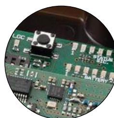
8 LED ROSSI STATO SICUREZZA 8 LED VERDI LIVELLO CARICA- BATTERIA
