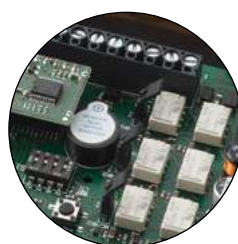
UNITÀ FISSA, GESTIONE USCITE DI SICUREZZA (NC/8,2kΩ)
