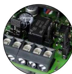
SELEZIONE USCITA RELÈ N.C. -N.A. O 8,2K \Omega TRAMITE JUMPER.
